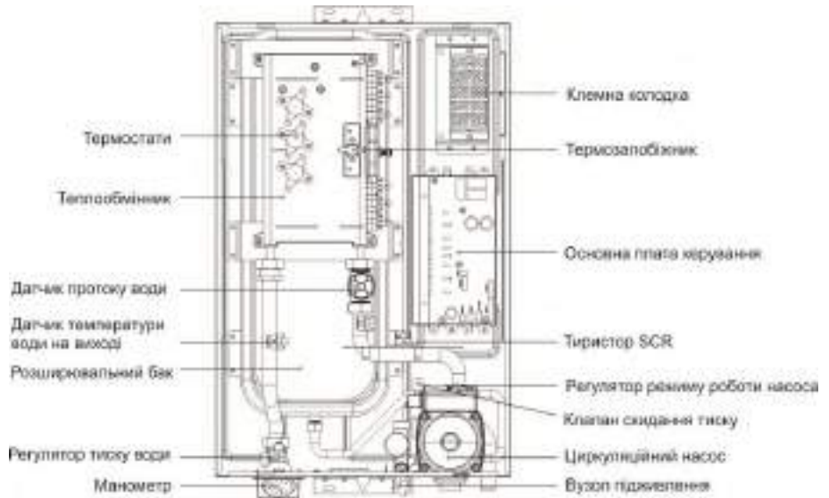
Мал. 2. Схема внутрішньої конструкції виробу
