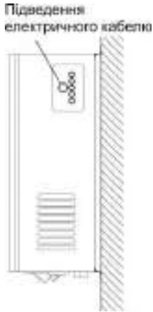
Мал. 10. Розташування панелі виводу електричного кабелю
