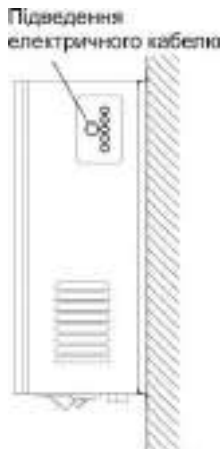
Мал. 10. Розташування панелі виводу електричного кабелю
