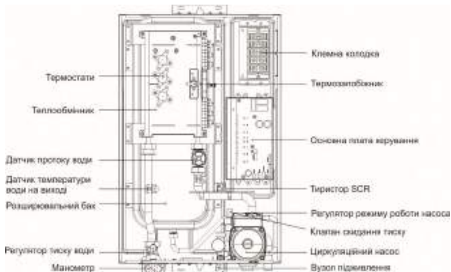
Мал. 2. Схема внутрішньої конструкції виробу
