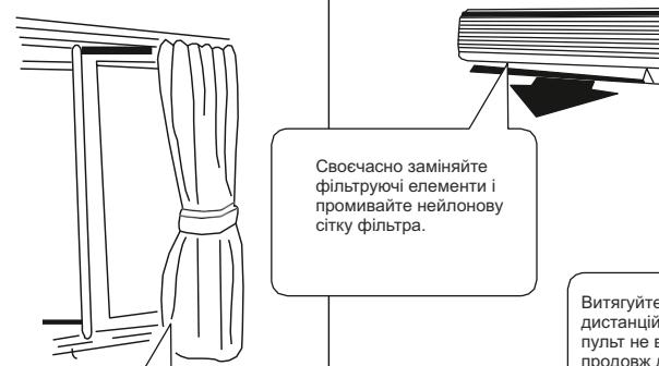
Своєчасно замінюйте фільтруючі елементи і промивайте нейлонову сітку фільтра.
